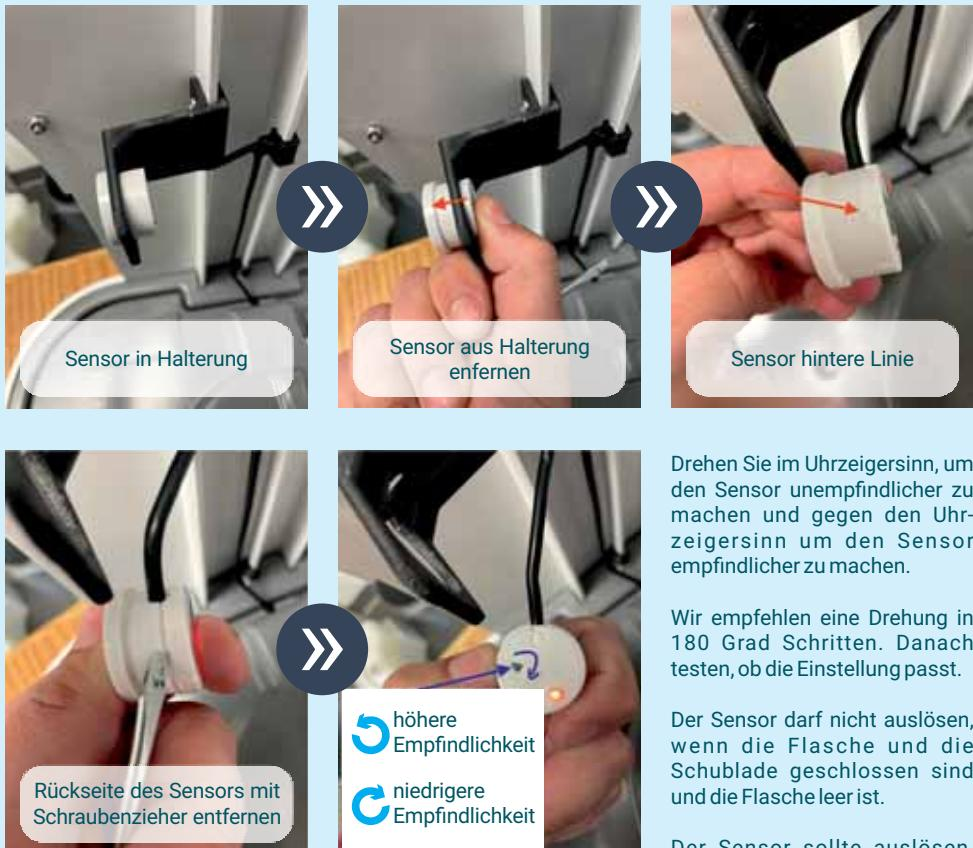
Der kapazitive Sensor der OGO Origin kann auch für externe Tanks verwendet werden. Dazu muss der Sensor nur entsprechend am externen Tank platziert werden (z. B. durch die Verlängerung des Sensorkabels). Danach muss der Sensor ebenfalls kalibriert werden.
